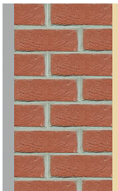
Bild 1: Istzustand der Aussenwand (ohne Dämmung). Links die Aussenseite.
